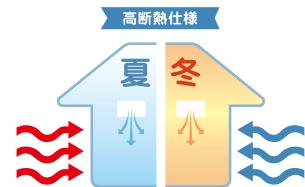
断熱性能は、外皮面積あたりの熱損失量を示す外皮平均熱貫流率(UA値)によって評価されます。長期優良住宅の基準にもなっている「断熱等性能等級4」は最高等級にあたりますが、そのUA値は5~8地域において0.87とあまりにも低い基準です。Arieでは快適性を確保するために、壁や天井に高性能断熱材を採用し、断熱性に優れた高性能樹脂サッシを併用することで標準仕様における想定UA値を0.47に設定しています。また、3地域以南(本州以南)においても、断熱等性能等級4を満たしており、国が定めるZEH基準もクリアしています。
